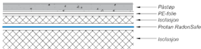
Bruksgruppe B, mellom isolasjonslagslag
